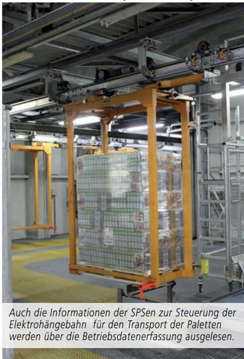
Auch die Informationen der SPSen zur Steuerung der Elektrohängebahn für den Transport der Paletten werden über die Betriebsdatenerfassung ausgelesen.
