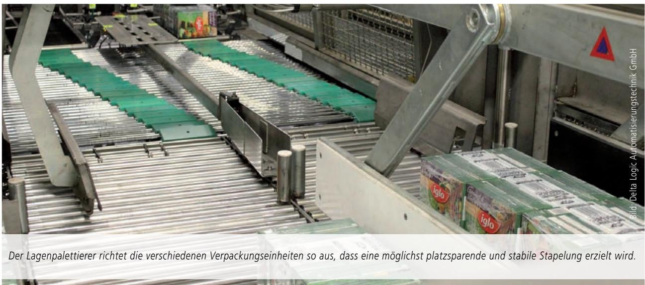
Der Lagenpalettierer richtet die verschiedenen Verpackungseinheiten so aus, dass eine möglichst platzsparende und stabile Stapelung erzielt wird.
