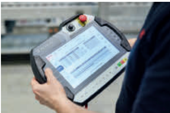
03 Accon-AGLink ist im ROP integriert, hardwareseitig über den Programmier-Adapter Accon-NetLink-Pro compact – damit gelingt die Vernetzung älterer Maschinen mit Systemen und Steuerungen der neuen Generation (Profibus, Ethernet)
